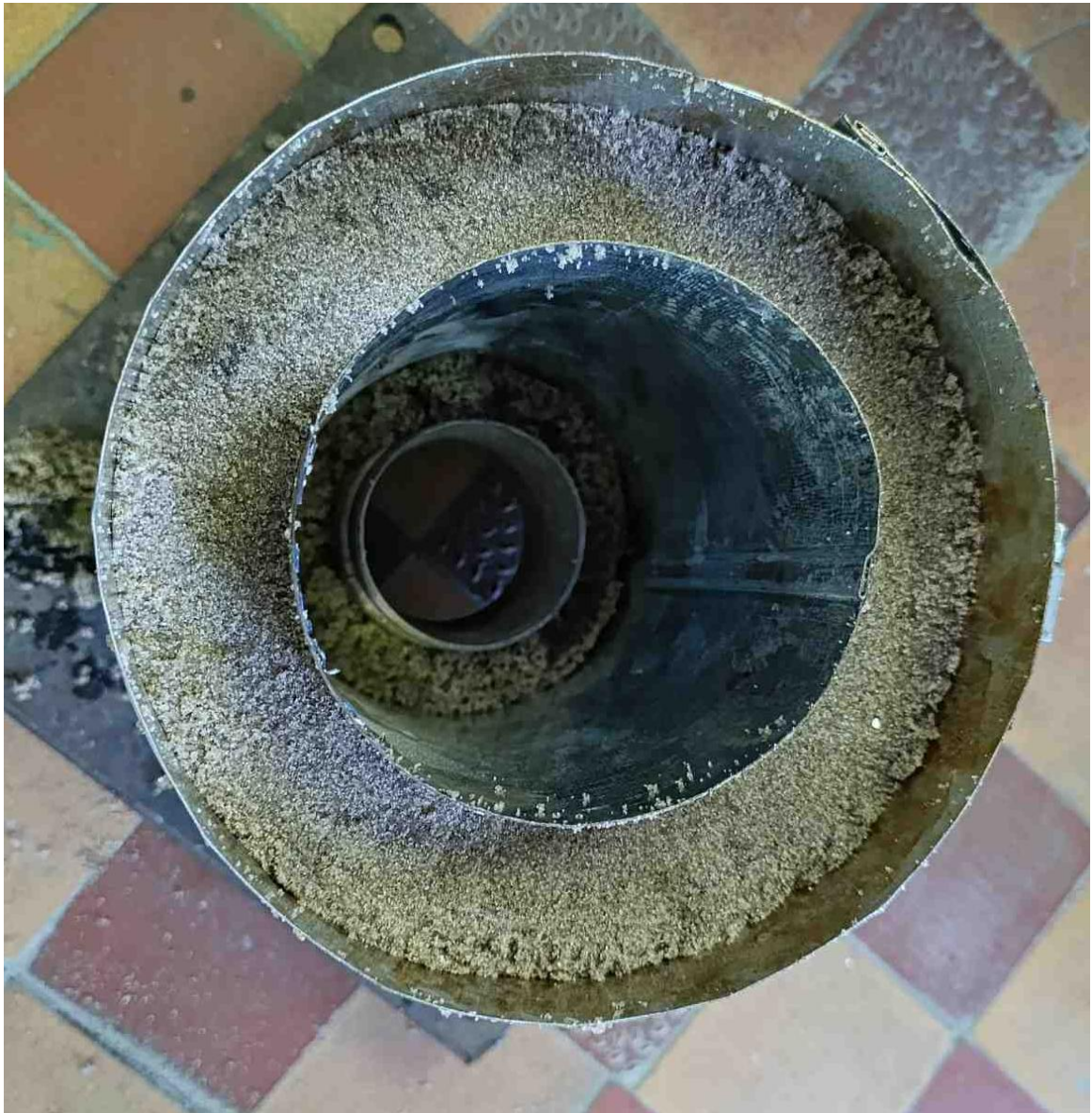
Рисунок 5.8 – Формування дослідного зразка БГЕ фільтра
