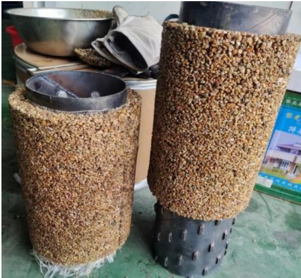
Рисунок 1.13 – Блоковий гравійний фільтр, виготовлений на основі епоксидної смоли
