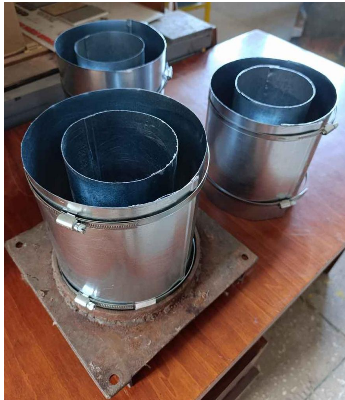
Рисунок 5.5 – Фотографія форми для виготовлення БГЕ фільтра
