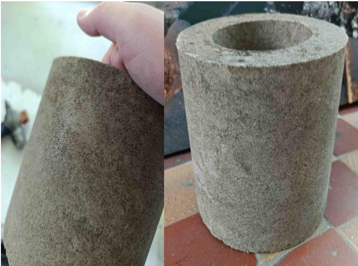
Рисунок 5.9 – Приклад якісного формування БГЕ фільтра
