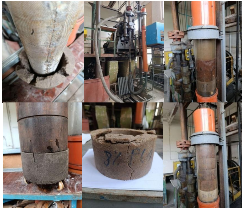
Рисунок 4.1 – Фотографія стендових досліджень БГЕ фільтра
