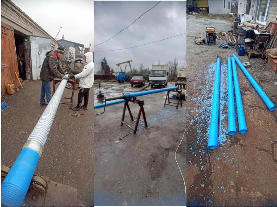
Рисунок 5.4 – Фотографії пороцесу виготовлення водоприймальної частини для фільтрової колони
