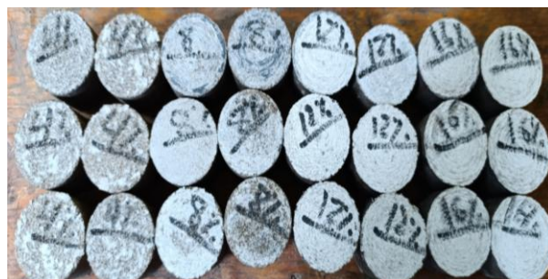
Рисунок 3.10 – Фотографія підготовлених циліндричних зразків БГК
