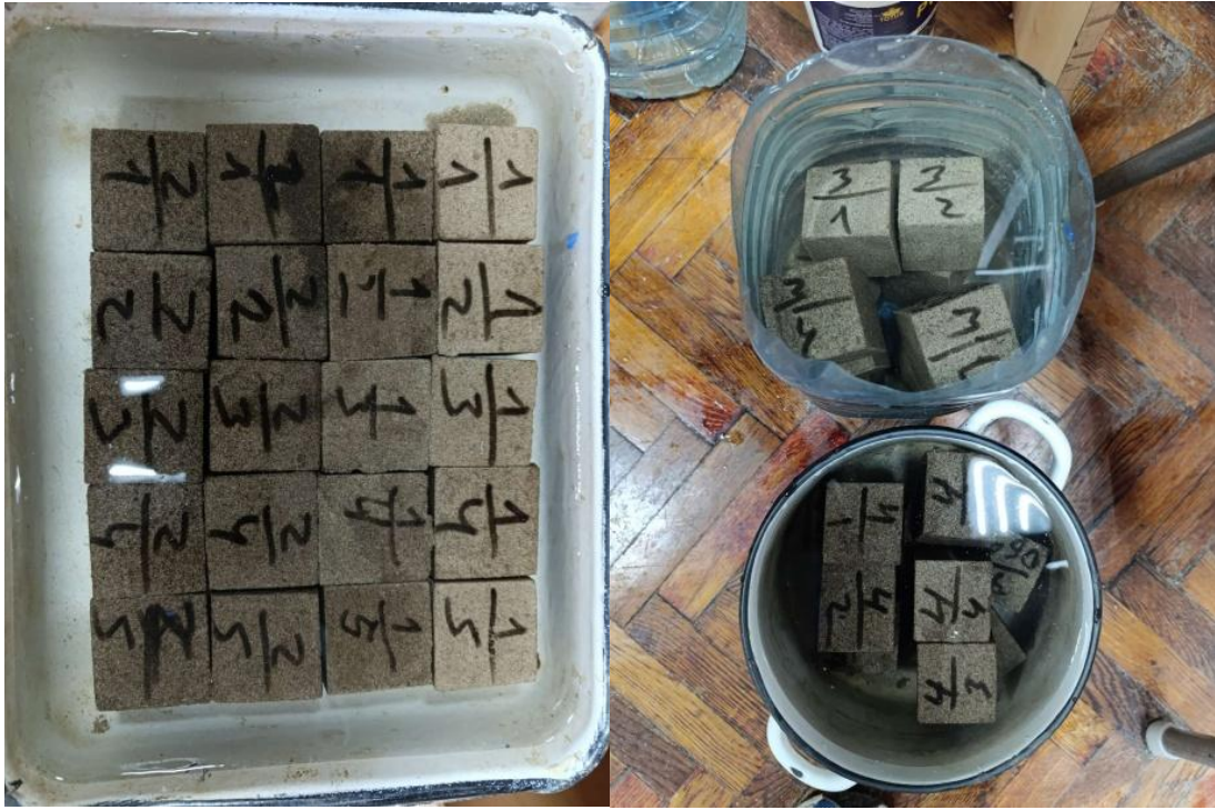
Рисунок 3.6 – Обводнення зразків БГК
