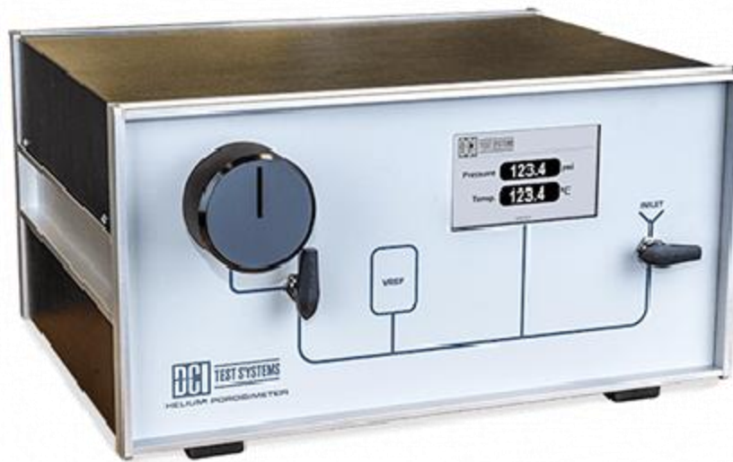
Рисунок 3.11 – Фотографія стенда DCI test systems helium porosimeter дослідження коефіцієнта пористості ( K_{пор} ) циліндричного зразка БГК
