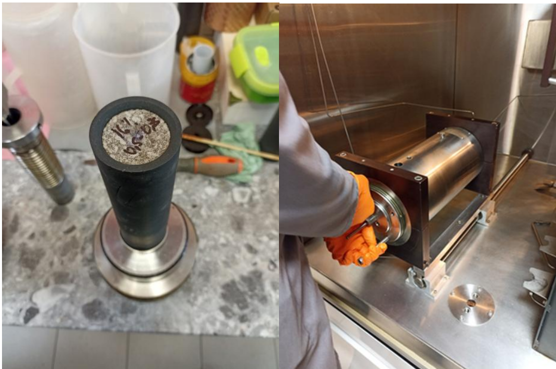
Рисунок 3.13 – Фотографія зі стендових досліджень зразків БГК на проникність
