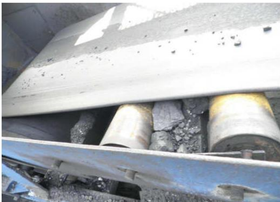
Рисунок 1.14 – Схід стрічки щодо поздовжньої осі і її тертя об конструкцію рами конвеєра
