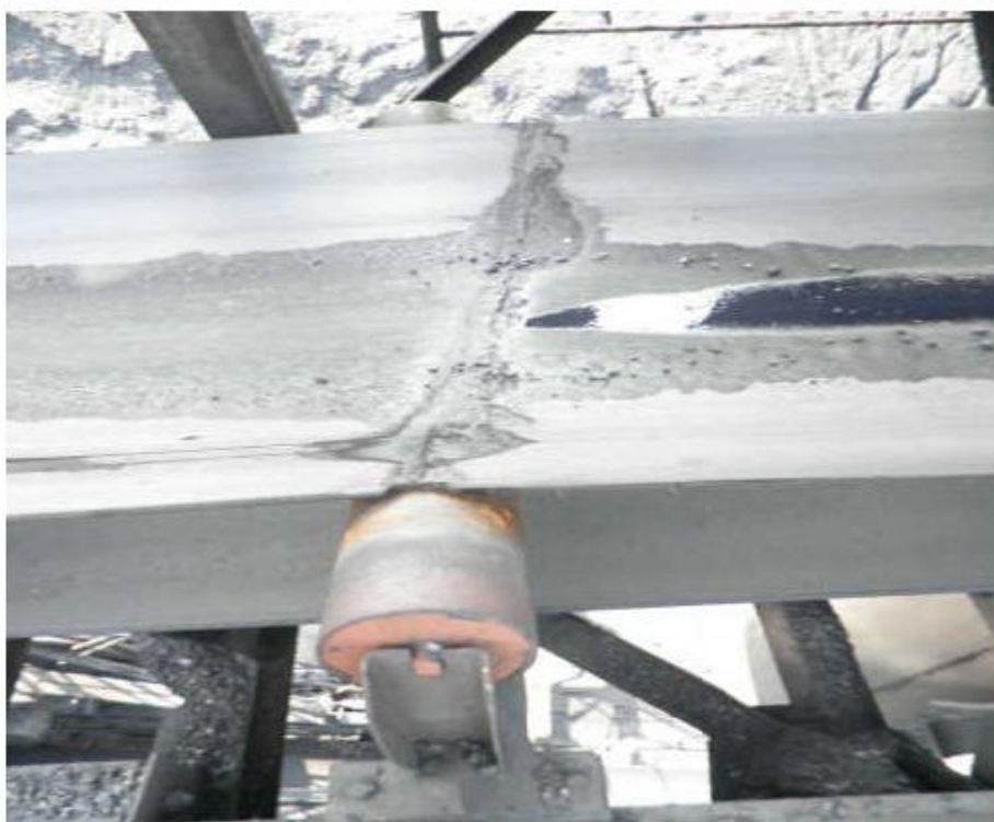
Рисунок 1.15 – Пошкодження стрічки на працюючому конвеєрі: а) – місцеве пошкодження стрічки; б) – пошкодження стику стрічки
