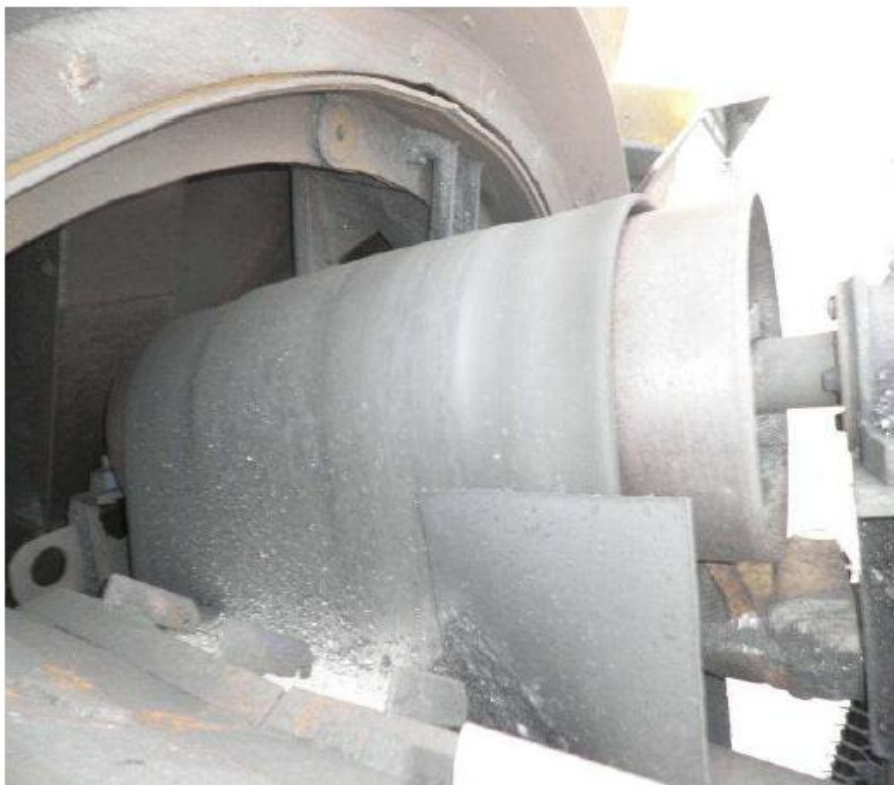
Рисунок 1.16 – Схід конвеєрної стрічки з приводного циліндричного барабана
