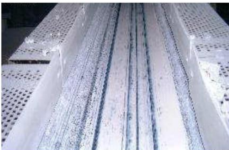
Рисунок 1.17 – Знос робочої поверхні стрічки
