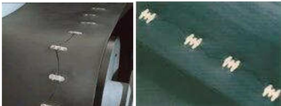
Рисунок 1.18 – Поздовжній розрив конвеєрної стрічки
