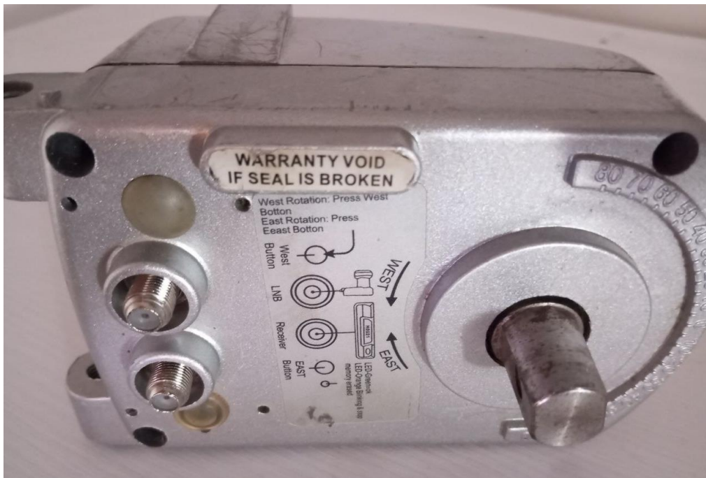
Рис. 4.5 Зовнішній вигляд мотопідвісу DiSEqC 1.2
