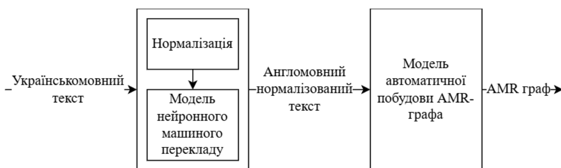
Рис. 3.3. Архітектура модуля нейронного машинного перекладу та нормалізації вхідних речень
