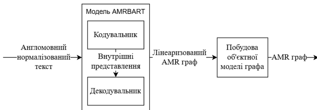
Рис. 3.4. Архітектура модуля трансформації англомовного тексту в AMR граф
