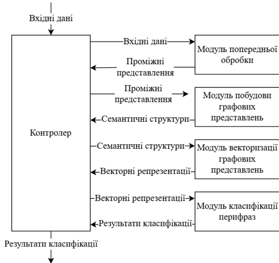
Рис. 3.2. Структурно-функціональна схема взаємодії модулів інформаційної технології
