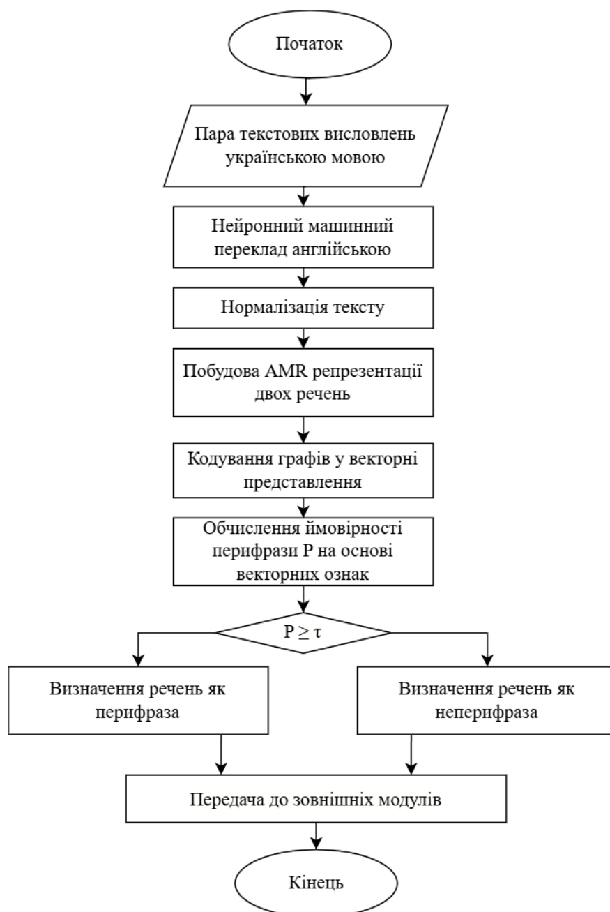
Рис. 3.8. Блок-схема алгоритму функціонування інтелектуальної системи ідентифікації перифраз
