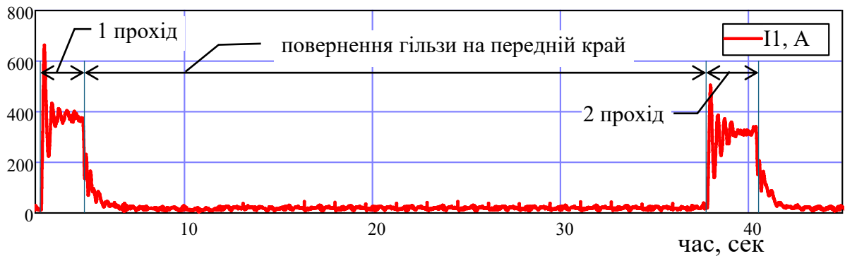
Рисунок 2.5 – Діючий струм статора упродовж двох проходів заготовки
