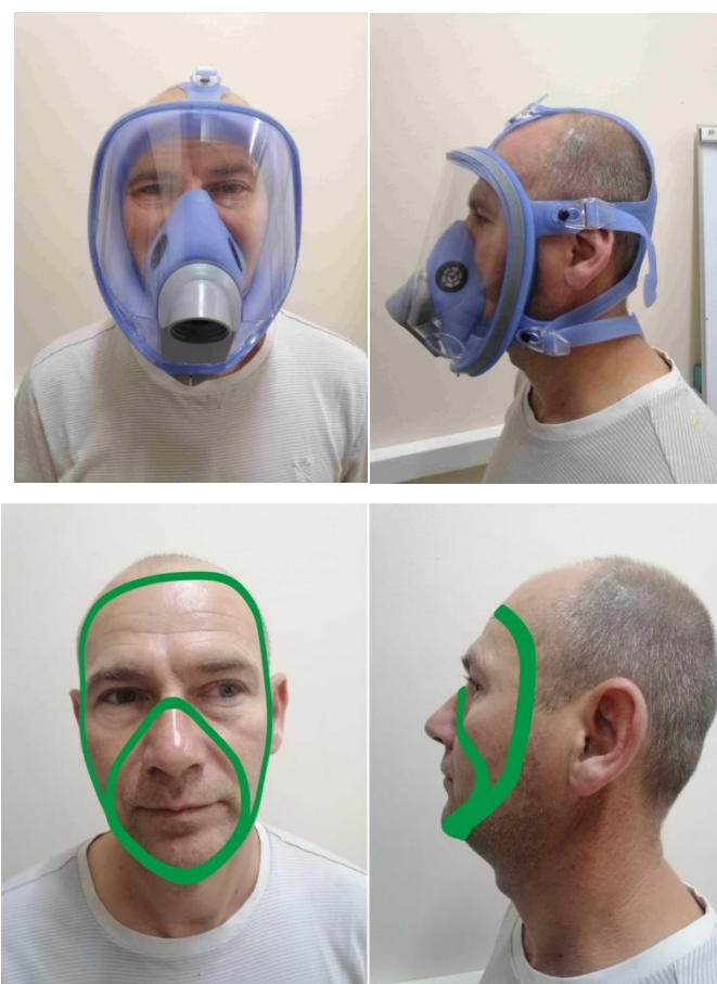
Рисунок 1.8 – Смуга обтюрації маски з підмасочником
