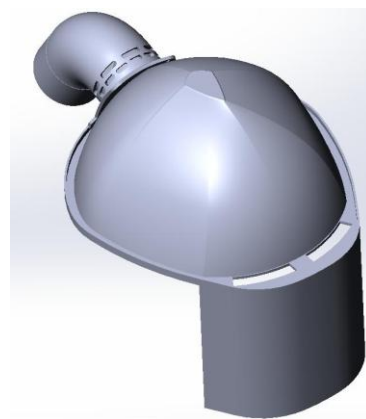
Рисунок 2.9 – Загальний вигляд головного гарнітуру з панорамним склом і системою активної щілинної вентиляції
