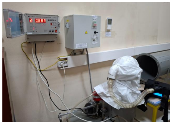
Рисунок 3.13 – Схема з визначення вмісту діоксиду вуглецю у вдихуваному повітрі [21]: 1 – дихальна машина; 2 – допоміжна легеня; 3 – односторонній клапан; 4 – витратомір; 5 – компенсатор; 6 – газоаналізатор \text{CO}_2 ; 7 – соленоїдні клапани; 8 – муляж голови; 9 – трубка для відбирання проб; 10 – поглинач діоксиду вуглецю
