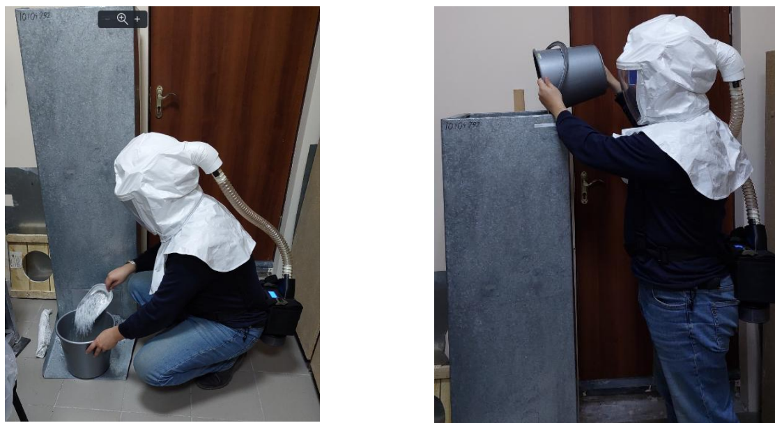
Рисунок 3.12 – Загальний вигляд випробувача при проведенні експлуатаційних випробувань з увімкненим МФР з капюшоном
