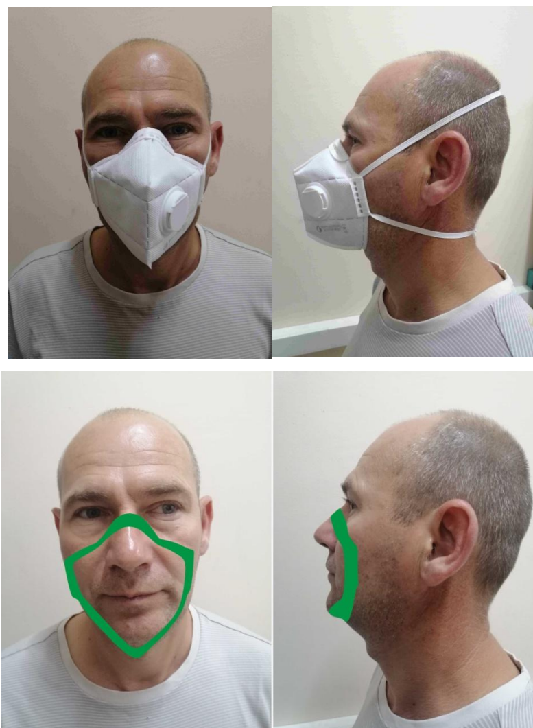
Рисунок 1.5 – Смуга обтюрації легкої фільтрувальної півмаски «Respy»
