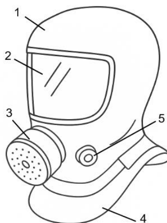
Рисунок 2.25 – Конструкція фільтрувального захисного капюшона:
