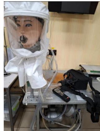
Рисунок 3.11 – Загальна схема установки з визначення опору диханню МФР
