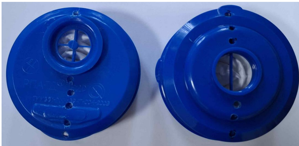
Рисунок 5.2 – Зовнішній вигляд корпусу фільтра з отворами для вимірювання перепаду тиску
