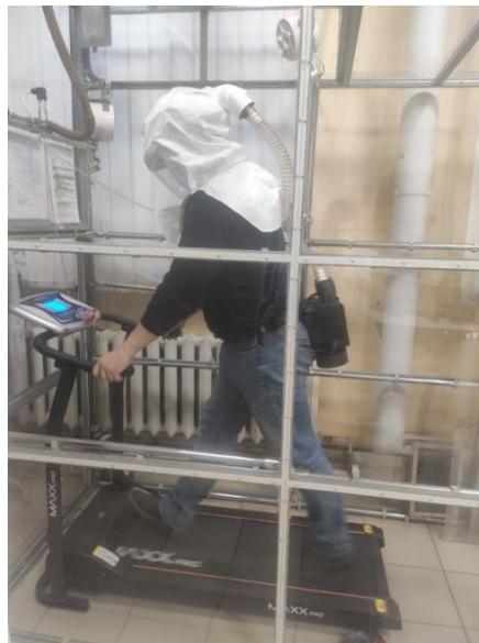
Рисунок 3.10 – Загальний вигляд випробувача в випробувальній камері з увімкненим МФР з капюшоном
