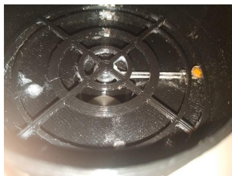
Рисунок 5.25 – Загальний вигляд фільтрувальної коробки з фільтром та важільною системою для виміру опору дихання ТРДТ
