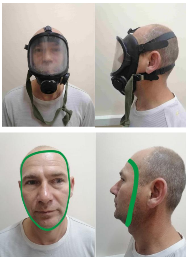
Рисунок 1.7 – Смуга обтюрації маски без підмасочника
