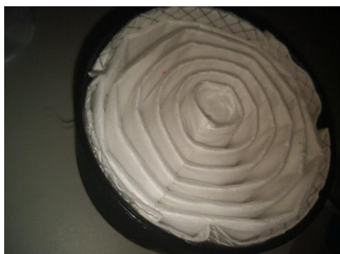
Рисунок 5.25 – Загальний вигляд фільтрувальної коробки з фільтром та важільною системою для виміру опору дихання ТРДТ
