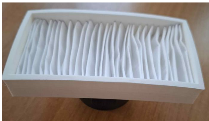
Рисунок 5.13 – Загальний вигляд експериментального зразка складчастого фільтра з 30 U-подібними складками
