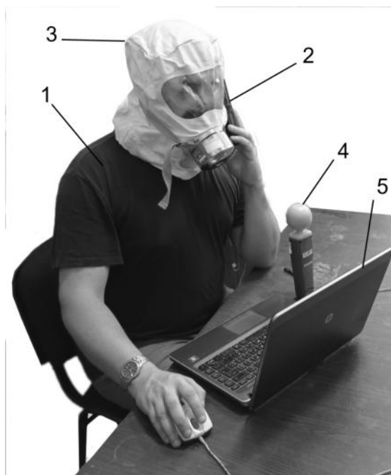
Рисунок 2.23 – Експериментальне дослідження впливу капюшону на розбірливість слів: 1 – випробувач; 2 – мобільний телефон; 3 – випробуваний капюшон; 4 – шумомір; 5 – ноутбук
