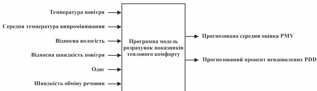
Рисунок 3.2 – Вхідні та вихідні параметри програмної моделі розрахунку параметрів теплового комфорту
