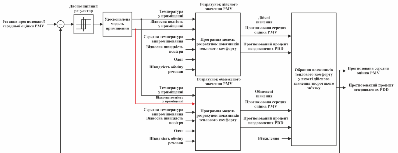
Рисунок 3.8 – Структурна схема моделі системи керування тепловим комфортом
