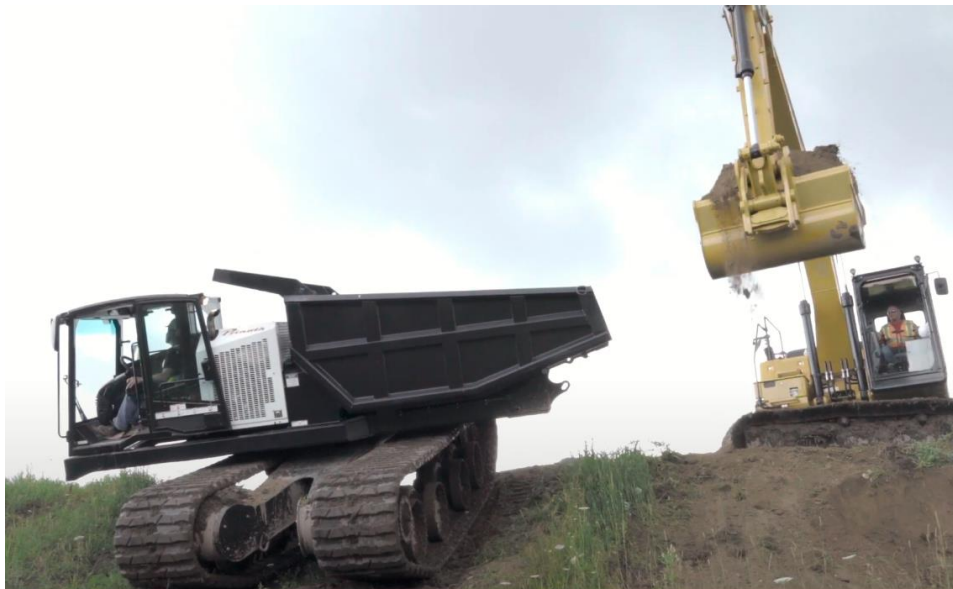
Рис. 2.4. Робота гусеничного автосамоскида з поворотною платформою.
