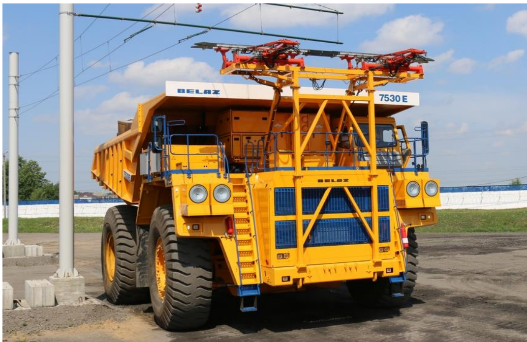
Рис. 1.3. Дизель-тролейвоз БілаЗ 7530Е.
