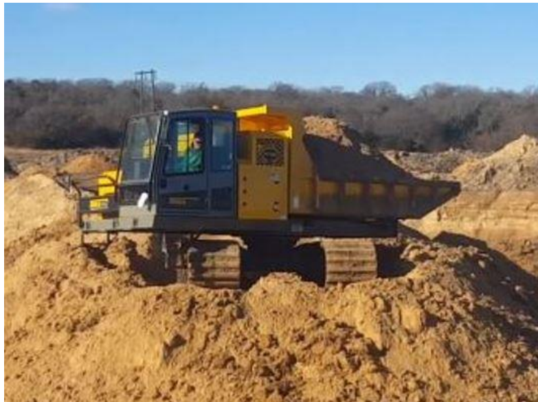
Рис. 1.12. Гусеничний автосамоскид Panther з повноповоротною платформою при відсипанні первинного відвалу.
