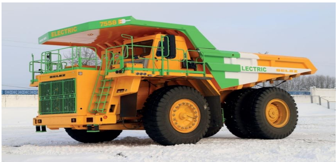
Рис. 1.2. Електросамоскид БілАЗ 7558Е.
