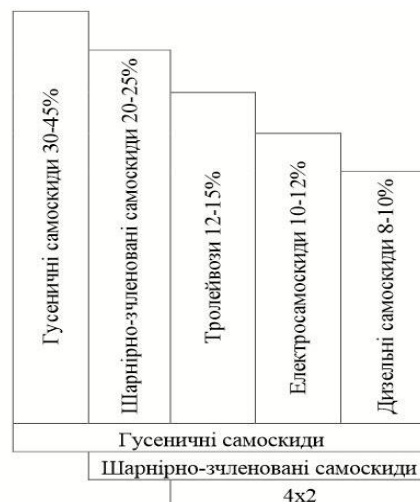
Рис. 3.25. Зони використання кар'єрних самоскидів (по ухилу дороги): 4x2 – колісна формула автосамоскиду.
