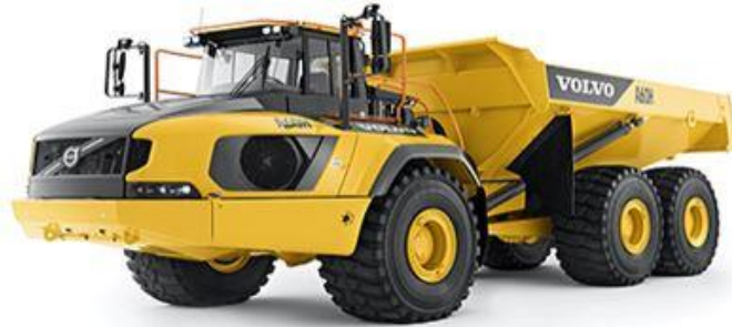
Рис. 1.4. Зчленований автосамоскид Volvo A60H.
