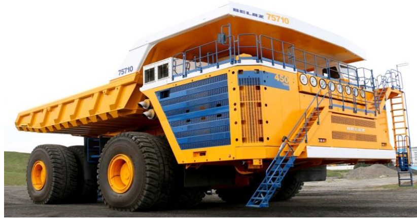
Рис. 1.1. Вид автосамоскиду БілАЗ 75710.
