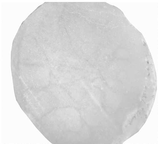
Рисунок 2.2 - Макроструктура поперечного перерізу скловолоконної арматури у стані поставки: характер розподілу волокон та полімерної матриці
