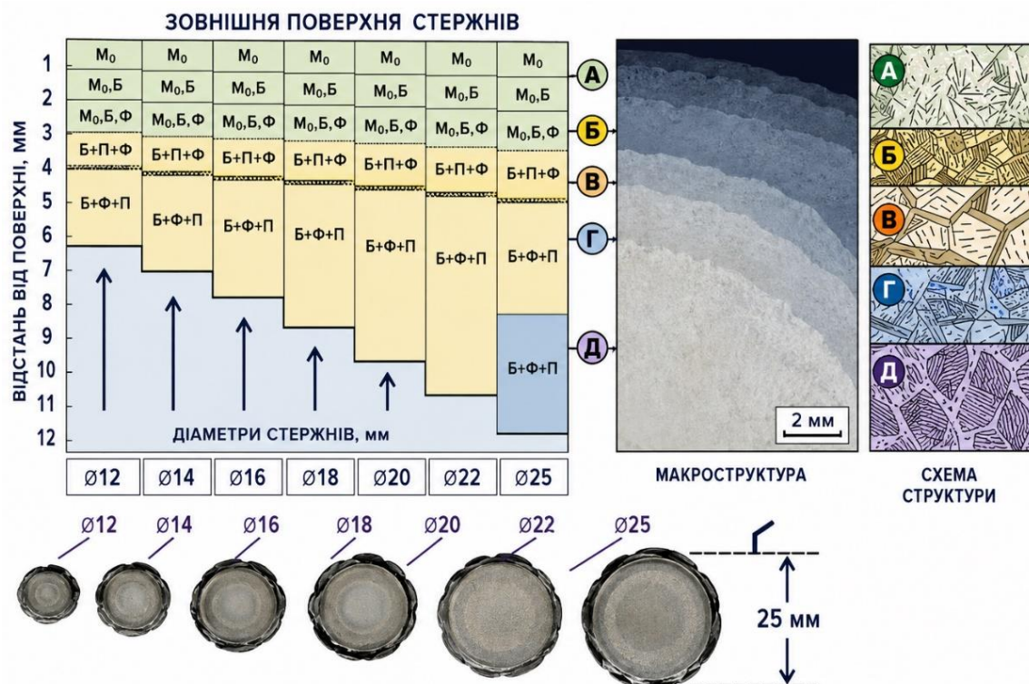
Рисунок 4.2 Формування структурних шарів за перерізом термічно зміцненої арматури класу А500С.
