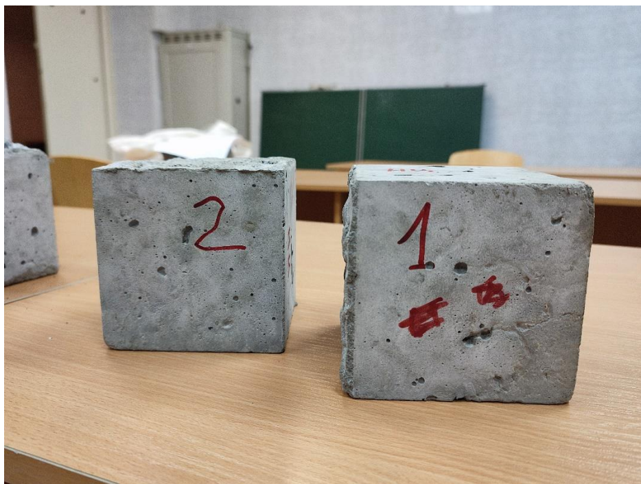
Рисунок 4.6 – Загальний вигляд бетонних зразків перед проведенням випробувань на статичний стиск.
