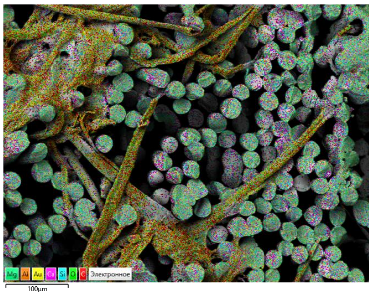
Рисунок 4.25 Карта розподілу хімічних елементів в композитній арматурі після нагрівання до 1000 °С
