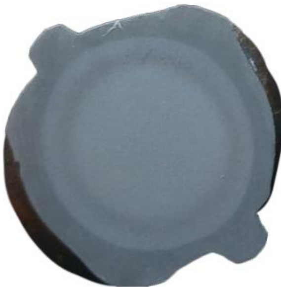
Рисунок 2.1 - Макроструктура поперечного перерізу арматурного стержня А500С у стані поставки з позначенням структурних зон А-Д
