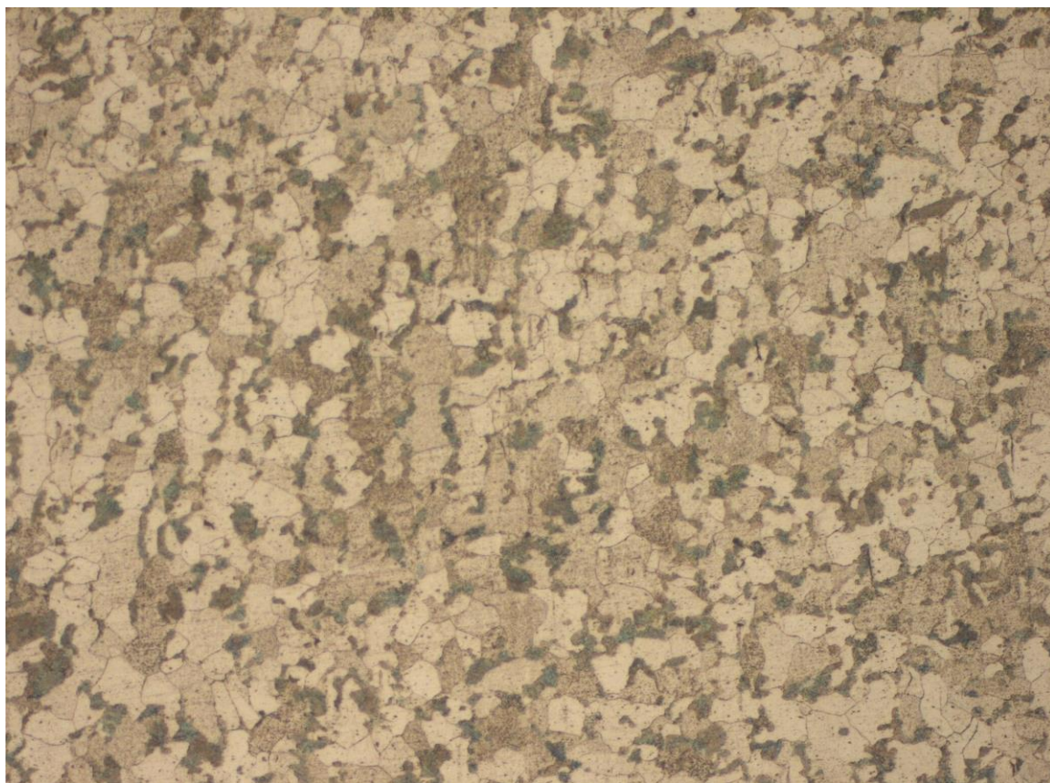
Рисунок 4.9 – Макроструктура арматури класу А500С після нагрівання до температури 1000 °С та охолодження разом із піччю x100.
