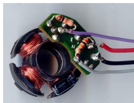
Рисунок 4.10 – Конструкція (а) та зовнішній вигляд модернізованої друкованої плати керування вентилятора HA4010V4 (б).
