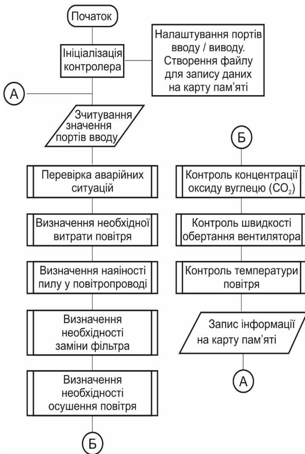
Рисунок 4.6 – Алгоритм роботи блока керування фільтрувального ЗІЗОД з примусовою подачею повітря
