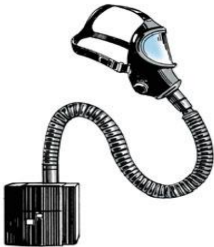
Рисунок 1.1 – Фільтрувальні ЗІЗОД з примусовою подачею повітря (PAPR)
