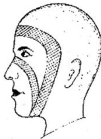
Рисунок 2.8 – Межі смуг обтюрації лицевих частин ЗІЗОД
