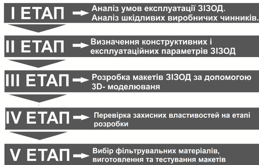
Рисунок 2.7 – Удосконалена процедура проектування півмасок
