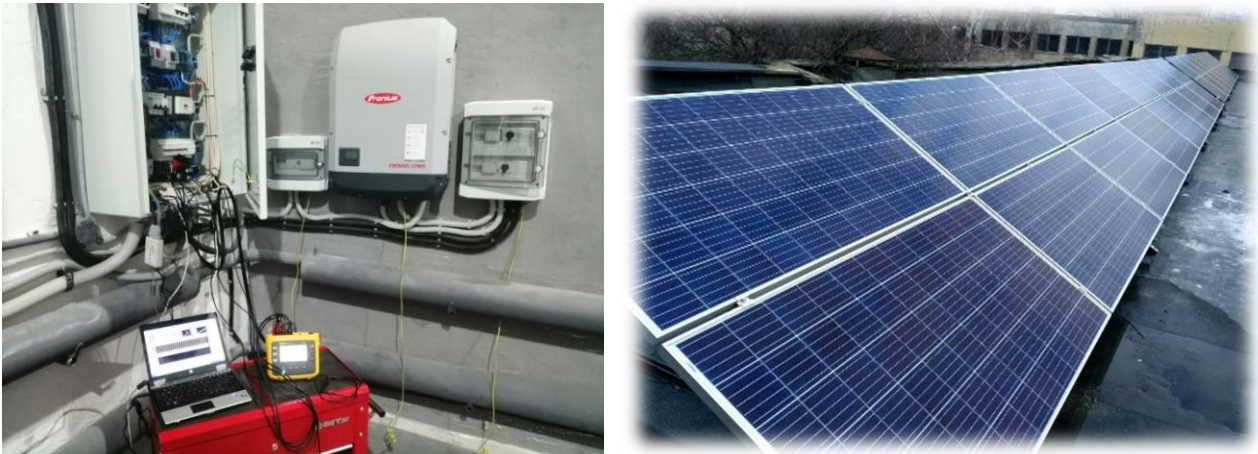
Рисунок 2.18 – Вимірювальний комплекс для дослідження електромагнітної сумісності мережевих інверторів ФЕС
