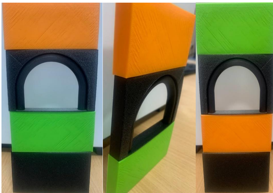
Рисунок 4.6 – Готові еквівалентні моделі для лабораторного дослідження на пресі
