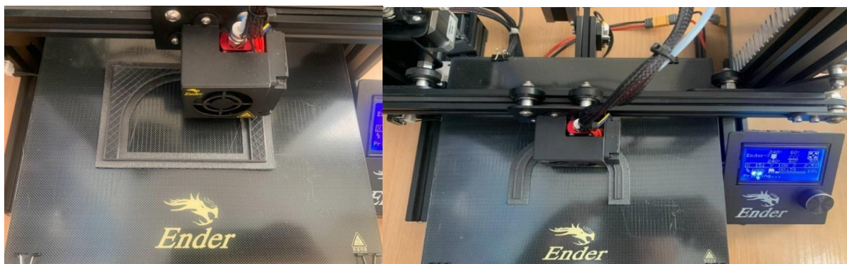
Рисунок 4.5 – Процес друку еквівалентних деталей на принтері
