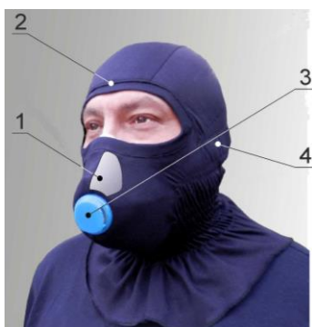
Рисунок А.1 – Комплексний засіб індивідуального захисту органів дихання та слуху швидкого припасування: 1 – напівмаска; 2 – балаклава; 3 – вузол клапана видиху, 4 – шумопоглинаючі пристрої
